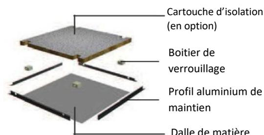
**Résistance thermique (R) 0,40 m<sup>2</sup> k/W**
