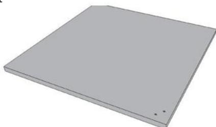
Découpe et pré perçage du volume dans ses quatre angles avec notre centre d'usinage numérique.
